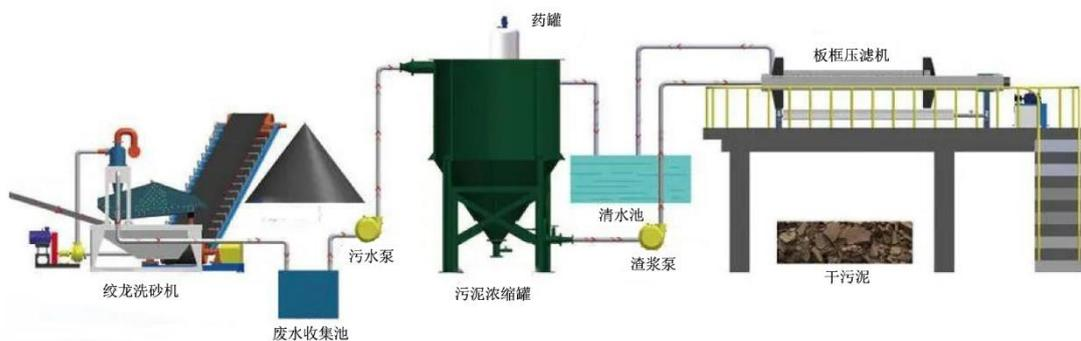
图 4-2 生产废水处理工艺流程图
